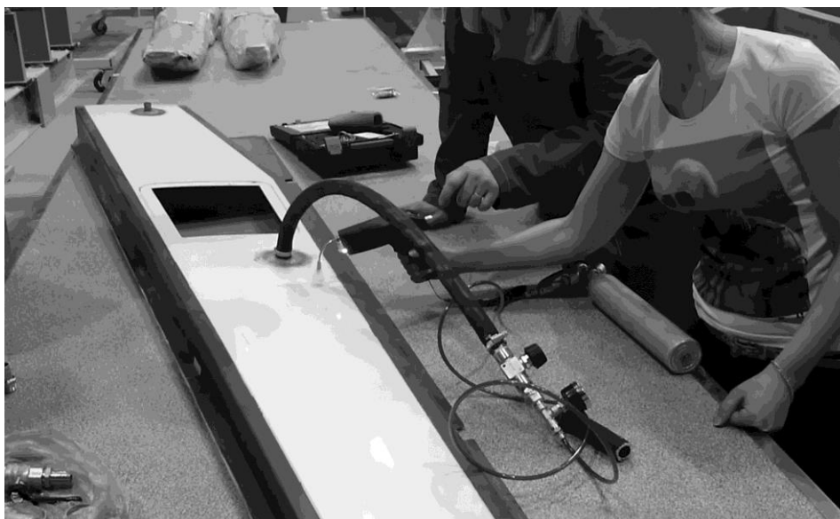
Рис.2. Контроль герметичности узла самолета при помощи портативного гелиевого течеискателя
