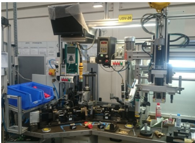
Рисунок 3 – Установка высокопроизводительного контроля герметичности запорной арматуры
