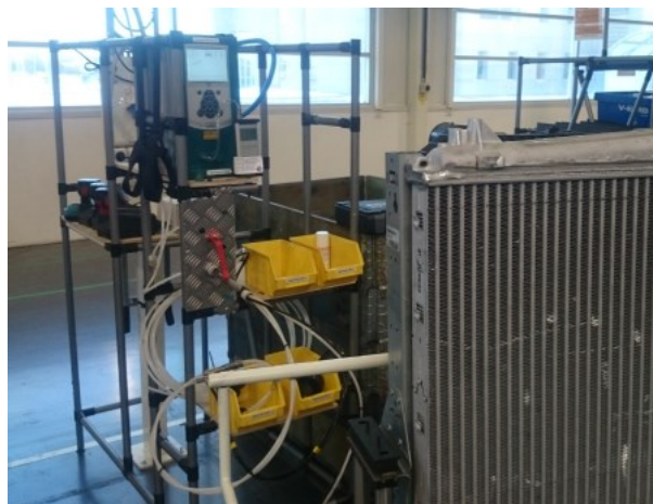
Рисунок 4 – Установка контроля герметичности радиаторов на автомобильном производстве
